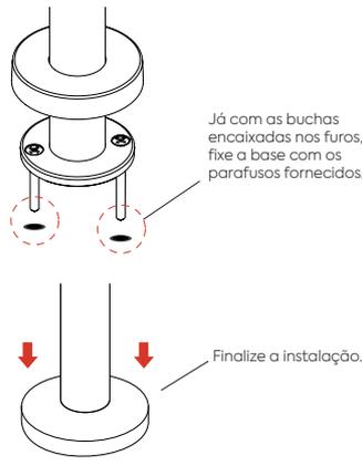
4. a) Modelo 7399 inserir haste regulável no tubo que contém a base, conforme foto.
